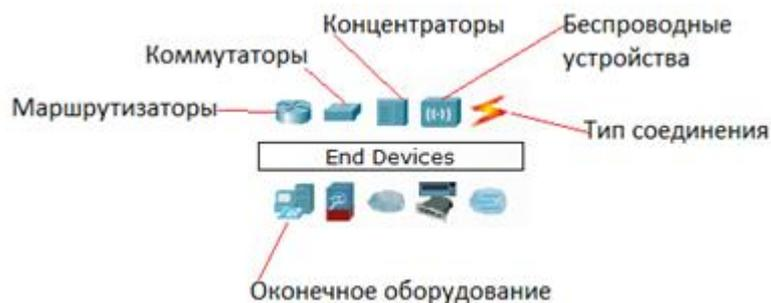
Рис. 5 Панель оборудования Packet Tracer (Основные типы оборудования)
